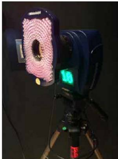
MotionAnalysis のモーションキャプチャーカメラ。 レンズ周りの LED から近赤外線が照射され、アク ターの光学センサーに反射したものを捉える光学 式。
