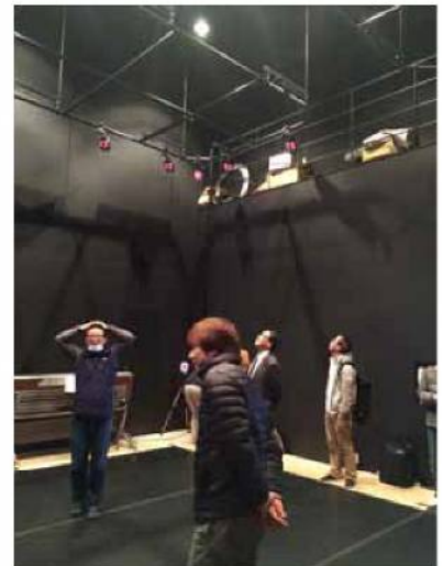
7F にもう一つのスタジオ。こちらは高さのあるスタ ジオになっており、キャプチャーカメラの高さが調 整出来るようになっていた。 このカメラは画素数が低いため、22 台で構成さ れていた。
