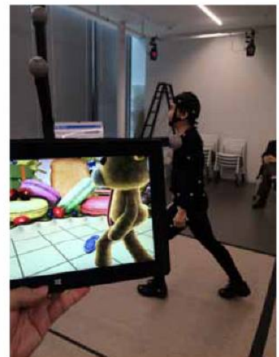
タブレットに光学マーカーをつけることで、バーチャルカメラで撮影した例。演者のモーションが、バーチャルスタジオ内でそのままのキャラクターとしてレンダリングされているのが分かる。
